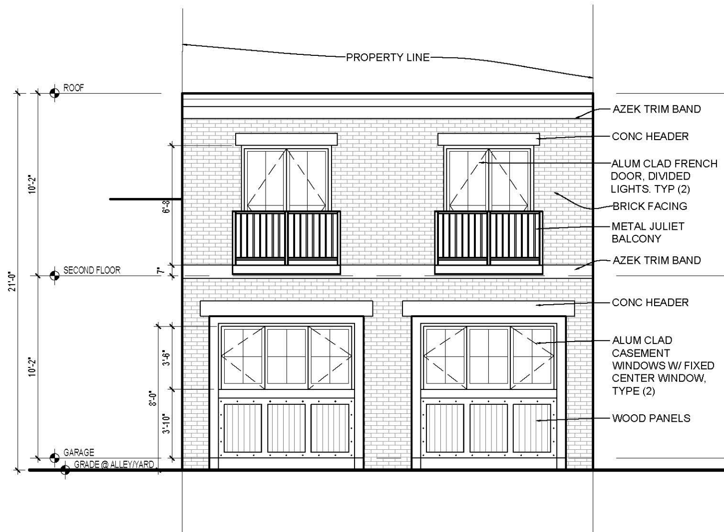
1 A-5 ALLEY ELEVATION SCALE: 3/16"=1'-0"
