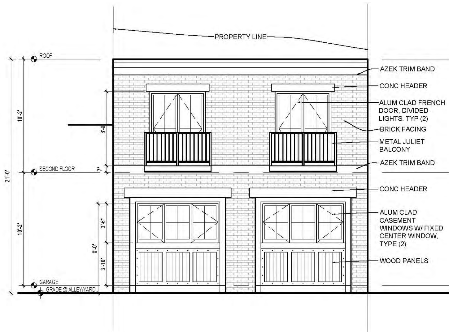
1 ALLEY ELEVATION A-5 SCALE: 3/16"=1'-0"
