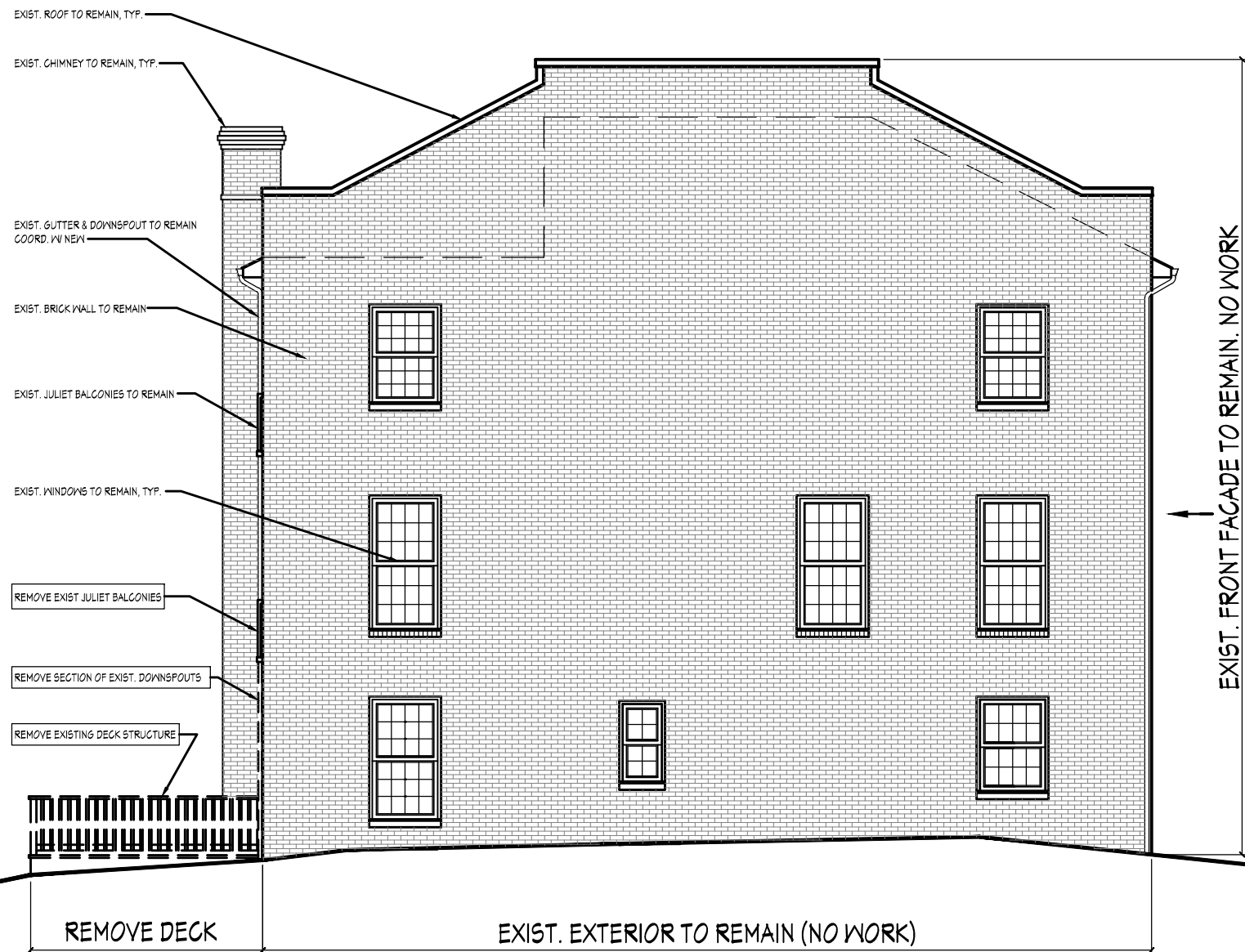
1 EXIST. WEST EXTERIOR ELEVATION (DEMO) A.2 SCALE: 1/8" = 1'-0"
